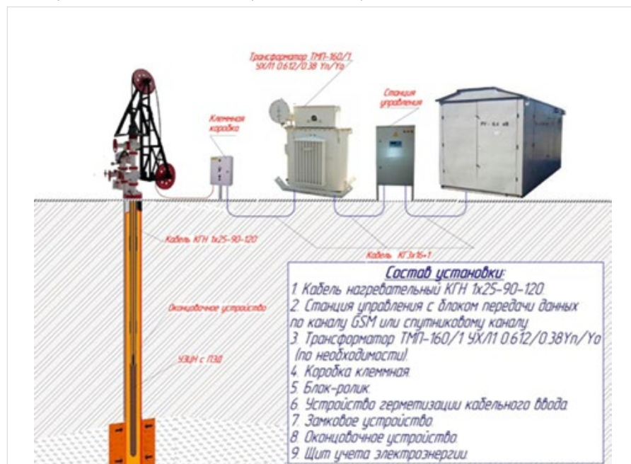
Рис. 1 — Установка прогрева скважин, оснащенных УЭЦН
