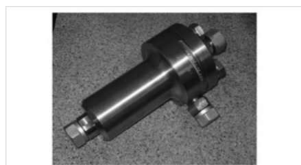
7 — Применение гидроциклонных сепараторов и забойных насосов специальной конструкции, устанавливаемые в обсадной (эксплуатационной) колонне с целью разделения смеси нефть/вода в стволе скважины
