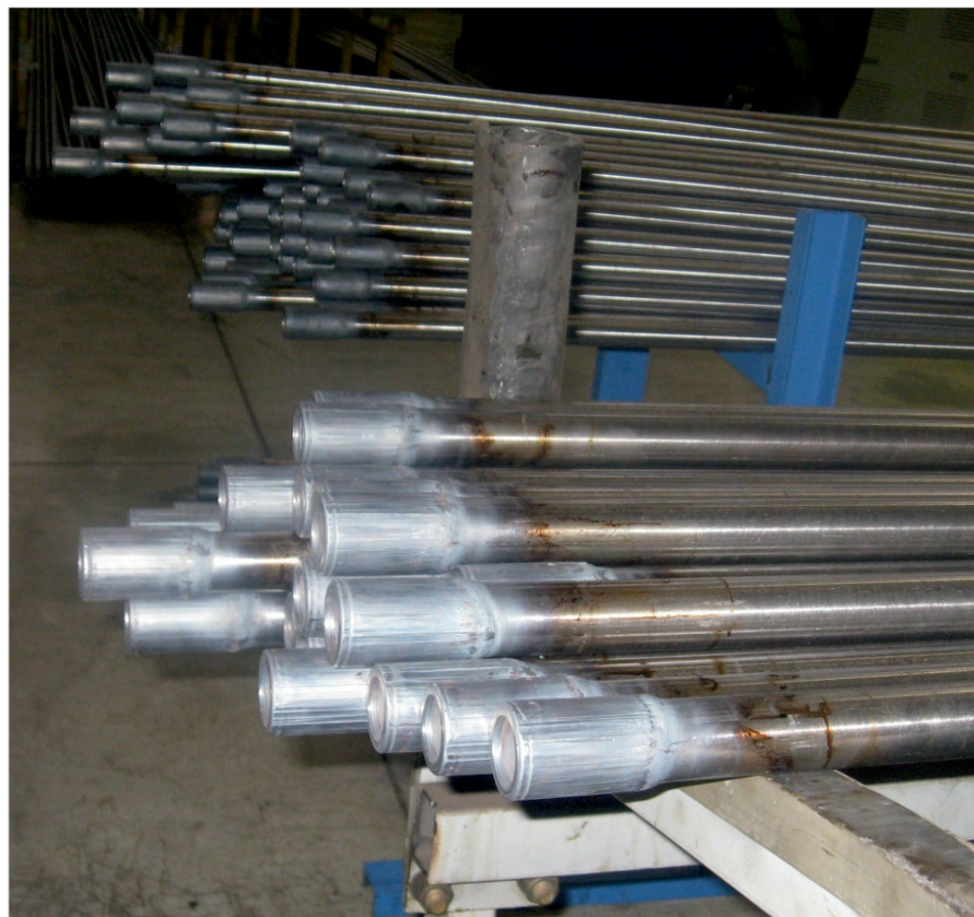
Рис. 7. Фото наплавленных головок на теле ШНП Fig. 7. Image of rod ends welded to hollow ShNP sucker rod body
