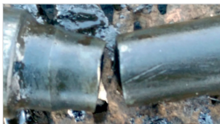
Рис. 3 Обрыв штанги на скважине № 3733 Fig. 3 Rod parting at the well № 3733
