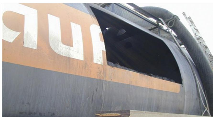
Рис. 3 – Гидроабразивная резка цистерны
