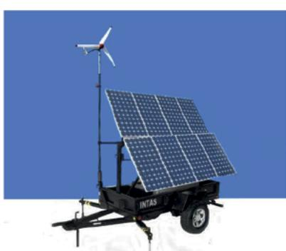
МОБИЛЬНАЯ ВЕТРО-СОЛНЕЧНАЯ ЭЛЕКТРОСТАНЦИЯ НА АВТОПРИЦЕПАХ – ЭТО ГИБРИДНАЯ СИСТЕМА ИНВЕРТОРНОГО ТИПА, ПОЛУЧАЮЩАЯ ЭНЕРГИЮ ОТ ВОСПОЛНЯЕМЫХ ПРИРОДНЫХ ИСТОЧНИКОВ (СОЛНЦЕ, ВЕТЕР) С ПОСЛЕДУЮЩИМ НАКОПЛЕНИЕМ ЭНЕРГИИ В БАТАРЕЕ АККУМУЛЯТОРОВ. ВХОДЯЩИЕ В КОМПЛЕКТ ДИЗЕЛЬНЫЕ ИЛИ БЕНЗИНОВЫЕ ГЕНЕРАТОРНЫЕ УСТАНОВКИ С АВТОЗАПУСКОМ ИСПОЛЬЗУЮТСЯ В КАЧЕСТВЕ РЕЗЕРВНОГО ИСТОЧНИКА.
