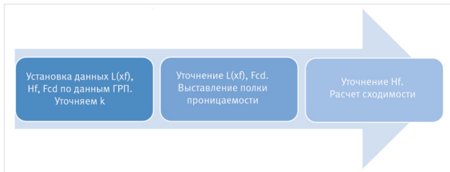
Рис. 4. Этапы уточнения параметров при интерпретации ГДИ
