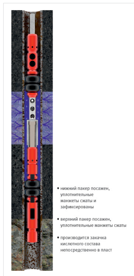
Рис. 2. Двухпакерная компоновка с телескопическим удлинителем готова для закачки кислотного состава в пласт при посаженном нижнем и верхнем пакерах
