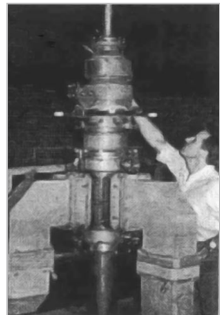
Рис. 6 Микроволновый плазмотрон для опытно-промышленного стенда Оренбургского газоперерабатывающего завода; мощность 500 кВт, частота 915 МГц.
