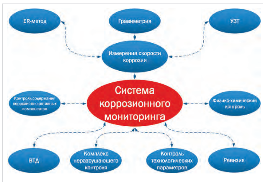
Рис. 2 — Концептуальная схема системы коррозионного мониторинга объектов ООО «Газпром добыча Уренгой», подверженных воздействию углекислотной коррозии Fig. 2 - Conceptual diagram of the corrosion monitoring system of Gazprom добыча Urengoy's facilities exposed to carbon dioxide corrosion.
