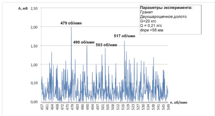
Рис. 4 — Спектр, соответствующий частоте вращения двухшарошечного долота с одной заклиненной шарошкой при разбуривании гранита с осевой нагрузкой 20 кгс
