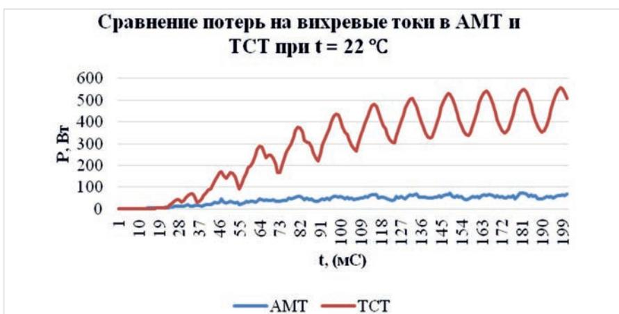
Рис. 4. Сравнение потерь на вихревые токи в АМТ и ТСТ
