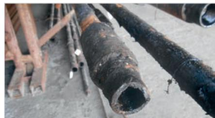
Рис. 4. Обрыв штанги на скважине № 9802
