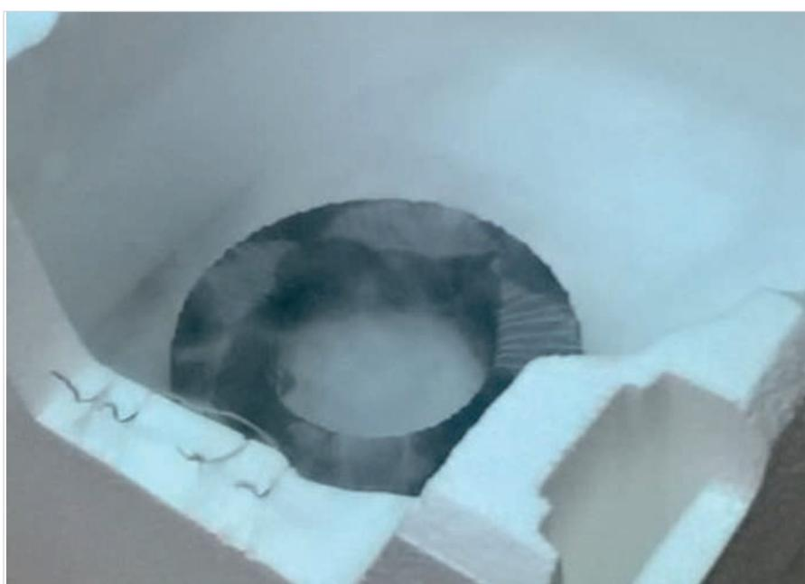
Рис. 5. Испытуемый образец трансформатора в ходе подготовки к замерам в криостате с жидким азотом
