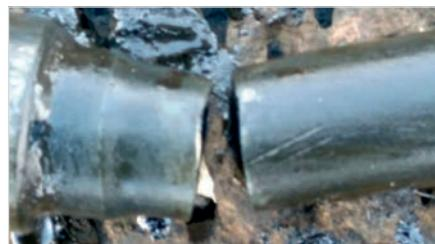
Рис. 3 Обрыв штанги на скважине № 3733
