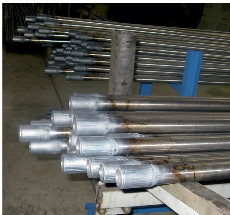
Рис. 7. Фото наплавленных головок на теле ШНП
