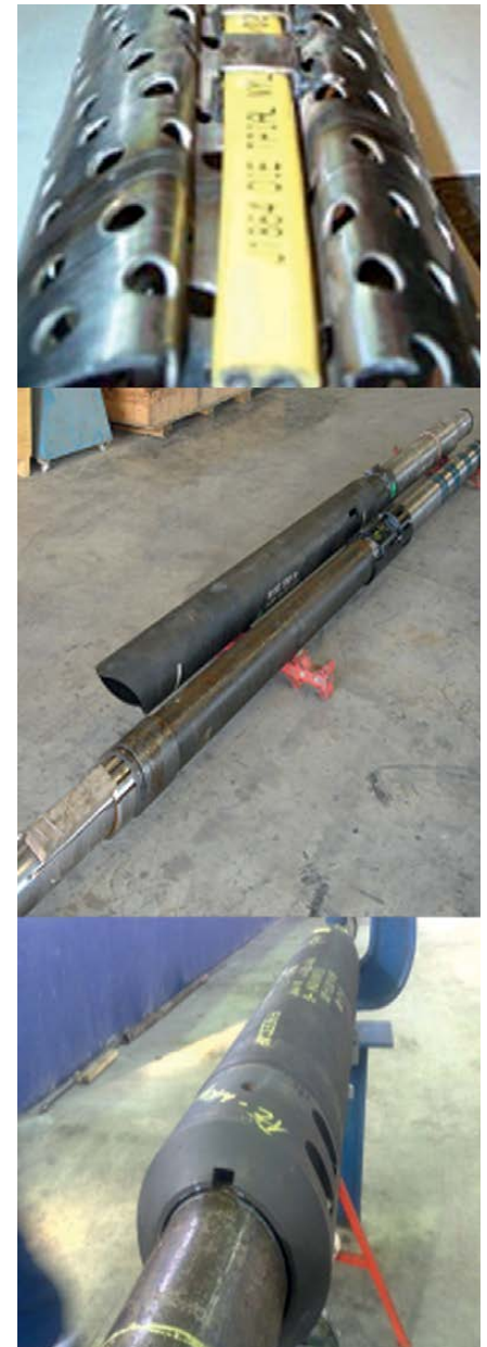
Рис. 3 — Противопесочный фильтр с проложенным оптоволоконным кабелем в плоской оплетке; стингер и приемник системы CLWM; разбухающие пакеры с проводными каналами
