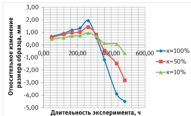
Рис. 2 — Зависимость относительного изменения образца эластомера от концентрации в растворе СНПХ-ПКД
