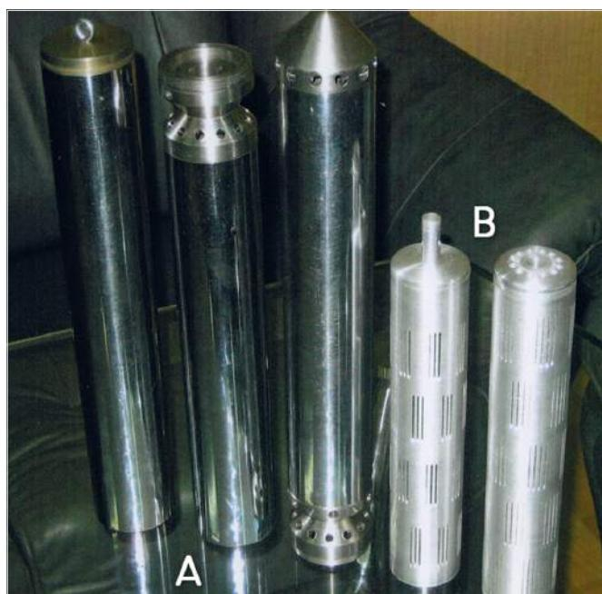
Рис. 3 — Элементы «ХИМОТЕРМ» для очистки «глухих» скважин
