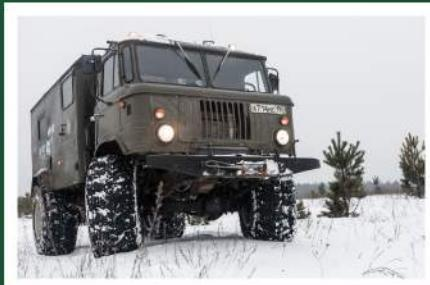
«SProfi 4X4» – это полноценные высококачественные пневматические шины низкого давления, предназначенные для вездеходов, среднетоннажных грузовиков, снегоболотоходов, эксплуатируемых в условиях бездорожья, на мягких и слабонесущих грунтах, а также на дорогах общего пользования всех категорий. Шины «SProfi 4X4» имеют диагональную конструкцию с регулируемым давлением, бескамерные.
