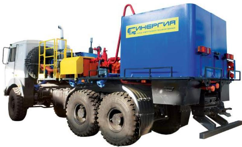
Рис. 2 — Установка для цементирования скважин СИН35.64
