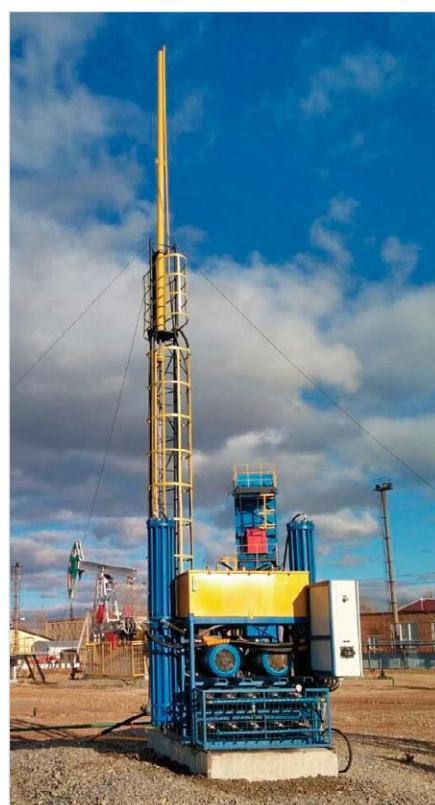
Рис. 1 – Привод гидравлический
