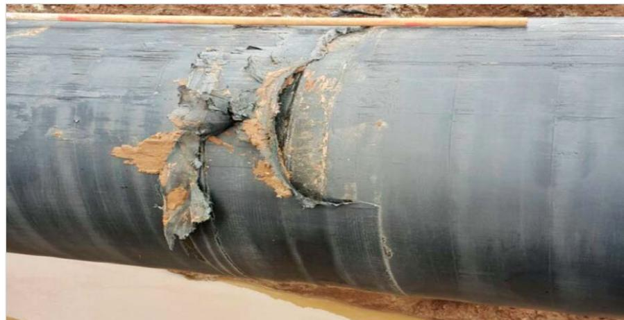
Рис. 2 — Нарушение изоляции трубопровода при нарушенной геометрии ствола скважины
