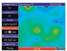
Для поиска и оценки характера расслоений, трещин и корродированных зон в трубной арматуре, «Томографик» УД4-Т с ЭМА датчиками в настоящее время является наиболее эффективным отечественным средством диагностики.
