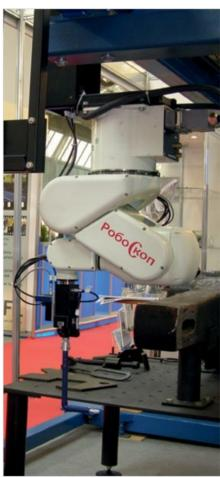
«Робоскоп 3000» — роботизированный комплекс неразрушающего контроля и лазерного обмера геометрических параметров
