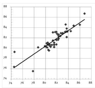
Рис. 1— Сходимость расчетного октанового числа катализатов цеоформинга и бензина «Нормаль-8о» (ось у) с ГОСТ 8226 (исследовательский метод, ось х) без учета поправки на плотность
