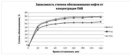
Рис. 1 — Зависимость степени обезвоживания нефтяной эмульсии от концентрации реагента
