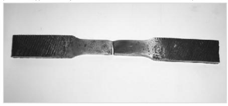
Рис. 1 — Образец материала трубы нефтепровода после циклического нагружения
