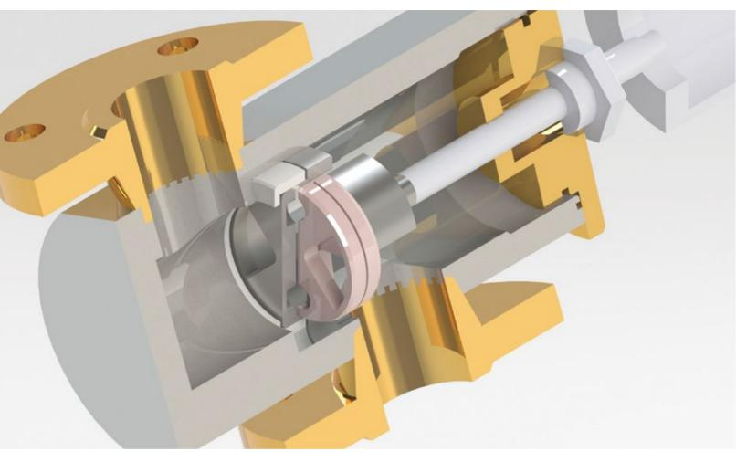
Разработанные нашим предприятием запорно-регулирующие клапаны с электроприводом во взрывобезопасном (1ExdIIBT4) или общепромышленном исполнении, позволяют обеспечить, без применения байпасных клапанов, широкодиапазонную, близкую к линейной, характеристику регулирования давления и расхода жидких, газообразных, парообразных и других сред в различных условиях работы.
