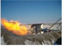
Рис. 3 — Установка АГГ1-А на промысле
