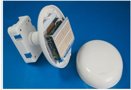
Рис. 1,2 — Электронные блоки микроволновых извещателей
