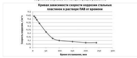
Рис. 2— Кривая зависимости скорости коррозии стальных пластинок в растворе ПАВ от времени
