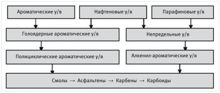
Рис. 1— Общая схема образования продуктов уплотнения при термическом разложении углеводородов
