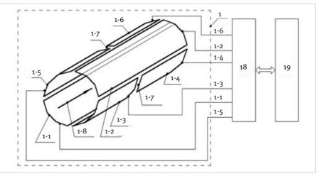
Рис. 1 — Конструктивные схемы шестиэлектродного (N=6) преобразователя с цилиндрическими электродами
