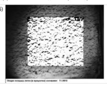
Рис. 3 — Компьютерная обработка выделенного фрагмента изображения реакции ДДИТ: а) N = 20 (тыс. цикл.),  $\sigma$  = 0,4262, б) N =80 (тыс. цикл.),  $\sigma$  = 11,9010
