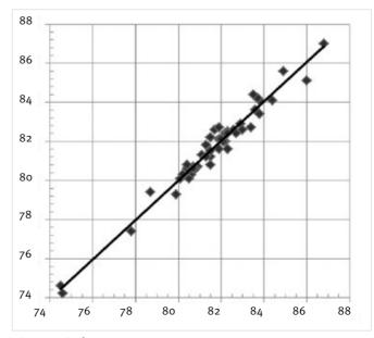
Рис. 2— Сходимость расчетного октанового числа катализатов цеоформинга и бензина «Нормаль-8о» (ось у) с ГОСТ 8226 (исследовательский метод, ось х) с учетом поправки на плотность
