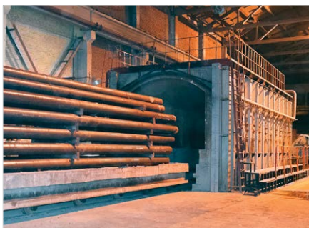
Рис. 3 — Печь для термического удаления жировых отложений с внутренней и наружной стальной поверхности труб
