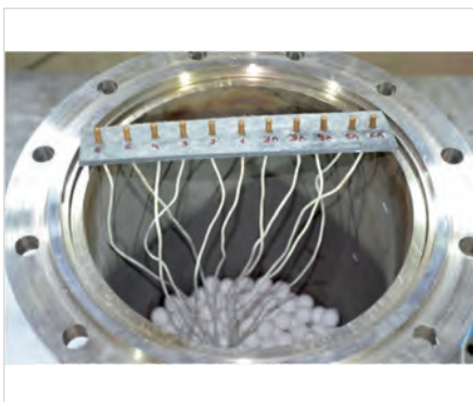
Рис. 2 — Блок термопар для замера поля температур
