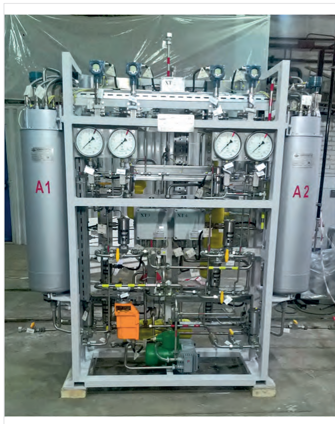
Рис. 4 — Установка подготовки импульсного газа УПИГ-00.000-30 (вид спереди)
