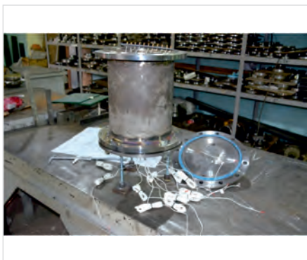
Рис. 1 — Реактор перед сборкой
