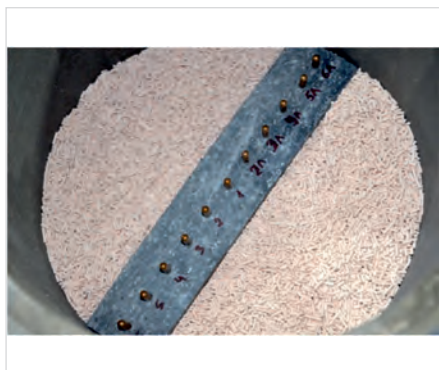
Рис. 3 — Монтаж блока термопар
