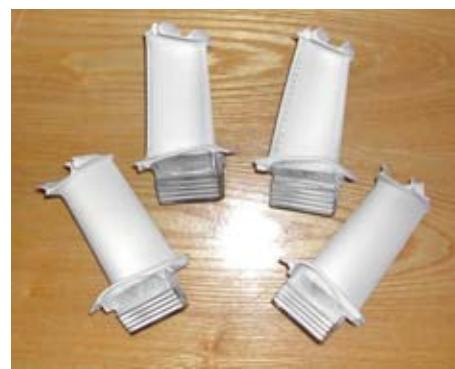
Восстановление и защита от высокотемпературной коррозии лопаток энергетических газотурбинных двигателей
