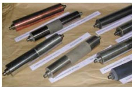
Образцы покрытий (медные, никелевые сплавы, нержавеющие стали, карбиды, керамика)
