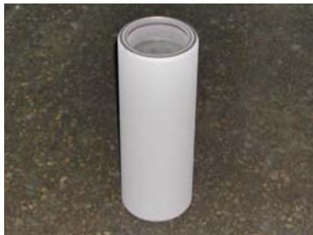
Восстановленная уплотнительная поверхность защитной гильзы насоса эрозии) поверхностей теплообменников, подвергающихся коррозии и золовой эрозии;
